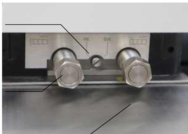
Connecteur pompe avec bouchons de fermeture
